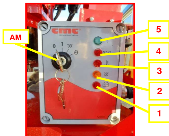
Afbeelding 4: bedieningspost start/stop motor.
